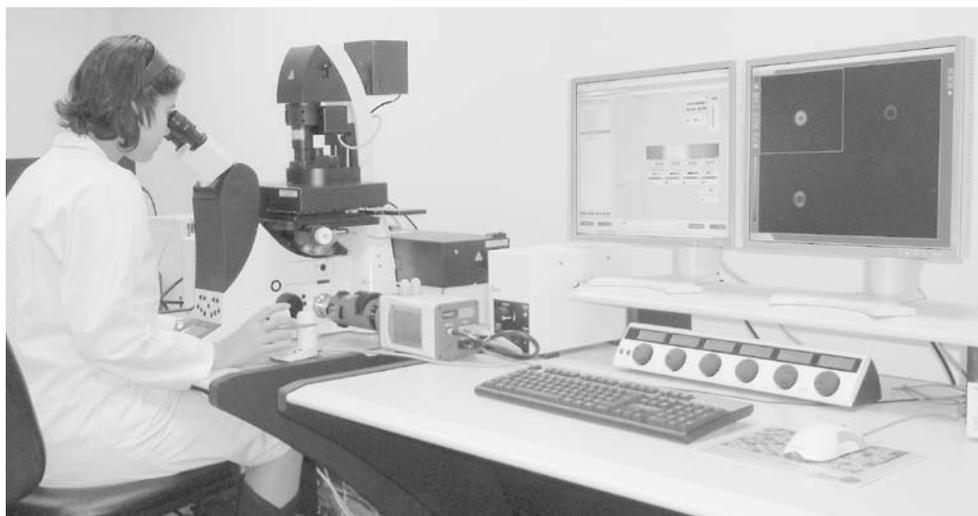
**La Plate-forme PRIMACEN a été récemment équipée, grâce à un financement FEDER, d'un nouveau système d'imagerie cellulaire composé d'un microscope confocal TCS SP5 X doté d'un laser blanc et d'un module TIRF (ondes évanescentes) en deux couleurs (© Leica).**
